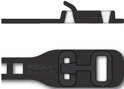
Softbinder mit Einfach-Verschlussystem bieten neben einer sanften und sicheren Befestigung eine Rückschlauföse. Das überstehende Bandende kann durch diese Öse geführt werden. So wird das Band gegen versehentliches Öffnen gesichert.
