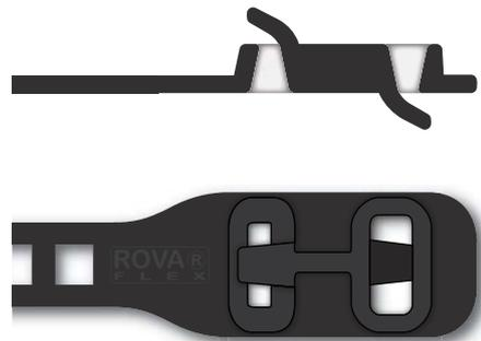
Softbinder mit Doppelverschluss bieten durch eine weitere Rastzunge am Verschluss die Möglichkeit nach der ersten Befestigung mit dem noch verbleibenden Band weitere Teile hinzuzubinden.
